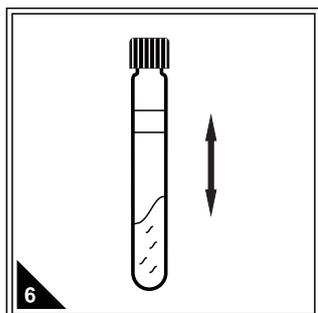
6 拧紧管盖，上下摇晃试管，使试剂与水样充分接触。
