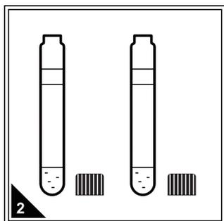
2 选择合适量程的预制试剂，一支作为空白样，再根据待测水样的数量选择相同数量的预制试剂作为待测样，拧开试管盖，置于试管架上。
