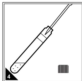
4 使用移液管或移液枪准确移取一定体积的无氨水加到预制试剂内制成空白样。
