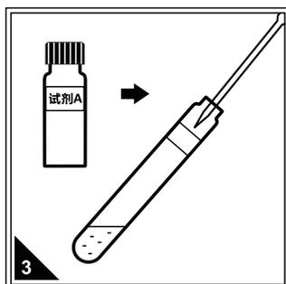
3 准确移取试剂A于每支试剂管中。
