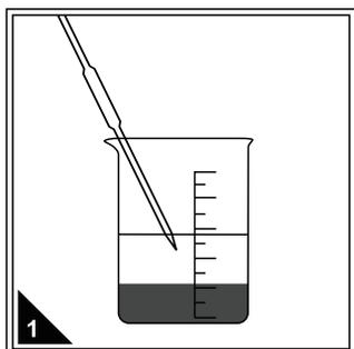
1 将待测水样按前处理要求进行蒸馏或絮凝沉淀等操作，保证待测水样澄清无颗粒物且透明。
