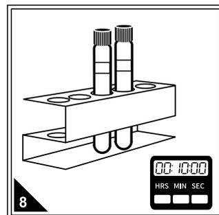
8 将试管样放在试管架内，使其反应并准确计时10分钟。
