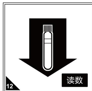
12 再放入待测水样，按读数直接读取氨氮浓度（mg/L以“N”计），期间无需开瓶盖，确保试剂为澄清状态，如有浑浊产生则不能进行读数。
