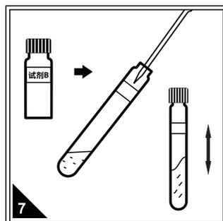
7 依次向各试管中加入1.00mL试剂B。拧紧管盖，上下摇晃试管，使试剂与水样充分接触。
