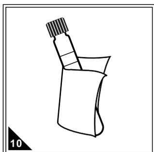
10 取出反应好的试管样，用擦镜布或无毛屑的软纸擦干净试管外壁，放入水质检测仪内进行比色操作（读数请在10分钟内完成操作）。
