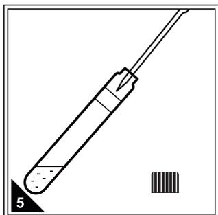
5 按步骤4的方法移取同体积的待测水样加入到其他预制试剂的试管内，每支预制试剂对应一个待测水样，制成待测样，记录试管上的编码。
