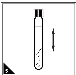
拧紧管盖，上下摇晃试管，使试管内的试剂与水样充分混合。
