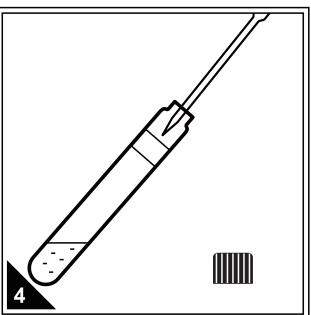
使用移液管或移液枪准确移取5.00mL蒸馏水，制成空白样。其他试管内准确移取5.00mL待测水样，制成待测样，记录试管上的编码。
