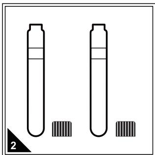
取若干试管，一支作为空白样，再根据待测水样的数量选择相同数量的试剂管作为待测样，拧开试管盖，置于试管架上。
