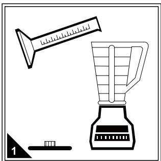
将待测水样按前处理要求进行混匀等操作。对于悬浮物较多的水样，应进行搅拌等匀质化处理，以减小取样误差。
