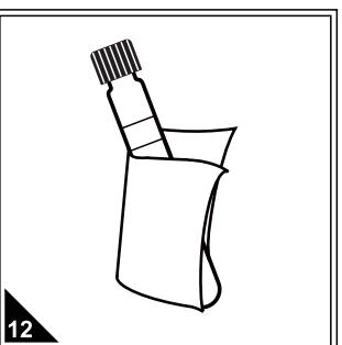
取出反应好的试管样，用擦镜布或无毛屑的软纸擦干净试管外壁，放入水质检测仪内进行比色操作。
