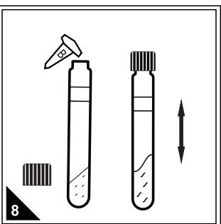
在冷却好的试剂中准确倒入一颗试剂B粉剂，上下摇匀使其完全溶解，时间约2分钟。
