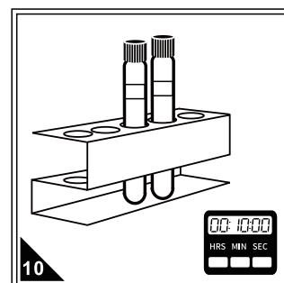
将摇匀后的试剂放在试管架中，静置使其反应并准确计时10分钟。
