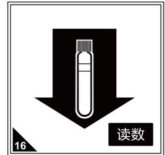
16 再放入待测样，按读数直接读取总氮浓度（mg/L以“N”计）。
