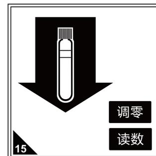
15 先放入空白样，按调零进行置零操作。再放入待测样，按读数直接读取总氮浓度（mg/L以“N”计）。
