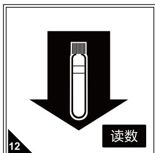
再放入待测样，按读数直接读取二氧化硅浓度(mg/L)，期间无需拧开瓶盖，必须保证试剂为澄清状态，如有混浊产生则无法进行读
