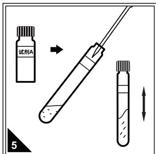
依次向各试管中加入1.00mL试剂A。拧紧管盖，上下摇晃试管，使试剂与水样充分接触。
