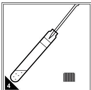
准确移取5.00mL待测水样于其余管中制成待测样，记录编号。
