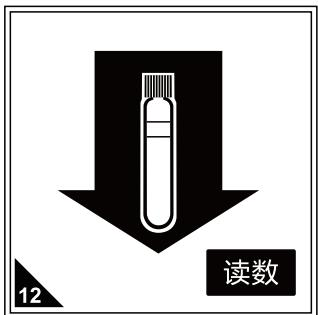
再放入待测水样，按读数直接读取镍元素浓度（mg/L），期间无需开瓶盖，确保试剂为澄清状态，如有浑浊产生则不能进行读数。
