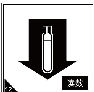
再放入待测样，按读数直接读取硝酸盐浓度（mg/L以“N”计），期间无需拧开瓶盖，必须保证试剂为澄清状态，如有混浊产生则无法进行读数。
