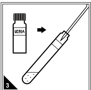
准确移取1.00mL试剂A于每支试剂管中。
